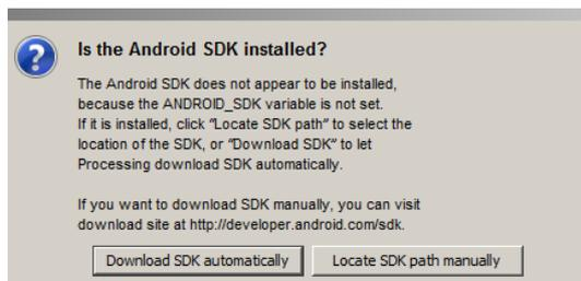
Dadurch werden automatisch nur die notwendigen Komponenten der `SDK` und nur die `SDK Plattform` des `API Levels 10`, d.h. für `Android 2.3.3` installiert.
