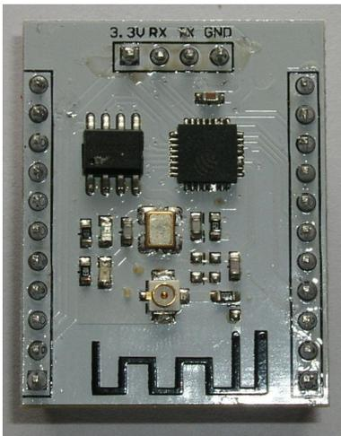
Abbildung 2: ESP-201 Modul (der ESP8266 µC ist der quadratische Chip).
